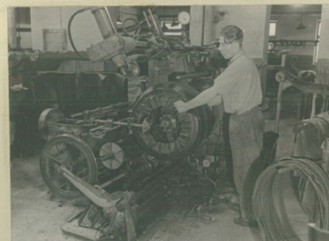
Сборка покрышек на станке СПД-3
