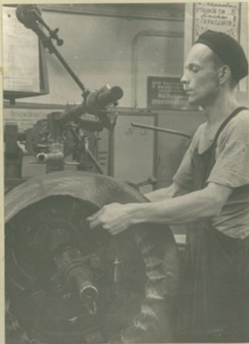
Обжимка кромок браслет на станке СПД-1 (до его модернизации)
