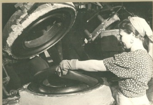
ПРИМЕНЯВШИЙСЯ РАНЕЕ НЕРАЦИОНАЛЬНЫЙ ПРИЕМ ОТРЫВА КАМЕР ОТ ФОРМЫ ПОДНЯТИЕМ ЕЕ В НЕСКОЛЬКИХ МЕСТАХ.
