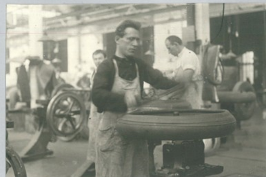
Одевание крыла на шаблон перед вставкой в каркас.
