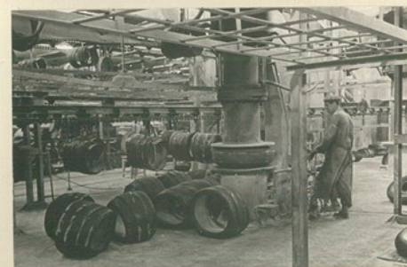
Воздушный форматор для грузовых и легковых покрышек с механизированной закладкой варочных камер. Производительность труда увеличилась в 2 раза.
