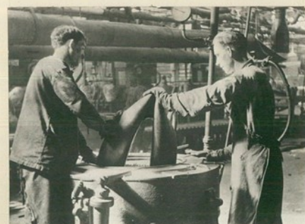
Вакуумный форматор для полуплоских покрышек с закладкой варочных камер вручную. В настоящее время применяется только для формования мотокамер.
