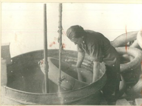
Испытание камер на герметичность в водяной ванне вручную.
