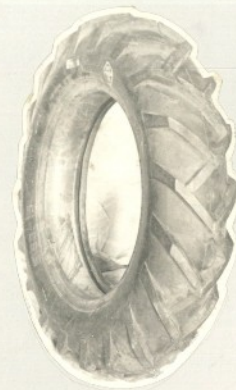
Шина разм. 5.50-16, мод. Л-9, для ведущих колёс горно-самоходной машины ЧУГ-1,6
