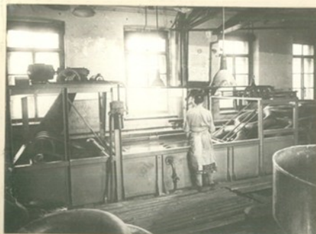
Устройство для механического испытания камер на герметичность улучшило качество испытаний при значительном облегчении труда.
