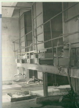
Изготовление ускорительных паст в пастомешалках, обеспечившее лучшее распределение ускорителей в резиновых смесях.
