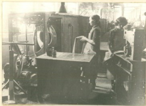
Сушильный конвейер. Снятие камерных рукавов с просушенными стыками и их прикатка на станке.
