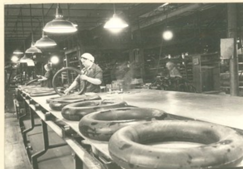
ПОТОЧНАЯ ЛИНИЯ НА ПРОВЕРКЕ И РАЗБРАКОВКЕ ГОТОВЫХ КАМЕР.
