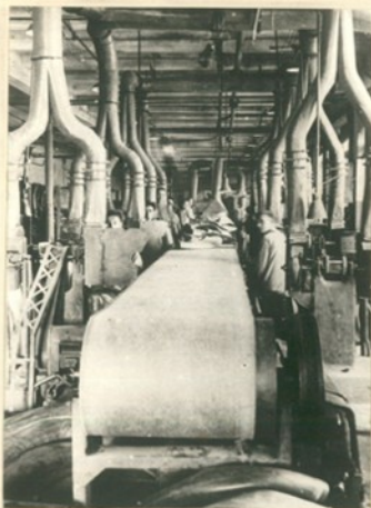
Конвейер для транспортировки камерных рукавов на участок шероховки и оттуда на последующую операцию.
