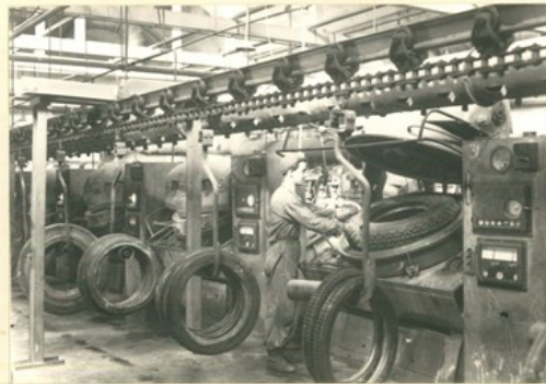
Транспортировка невулканизованных и вулканизованных покрышек в цехе вулканизации.
