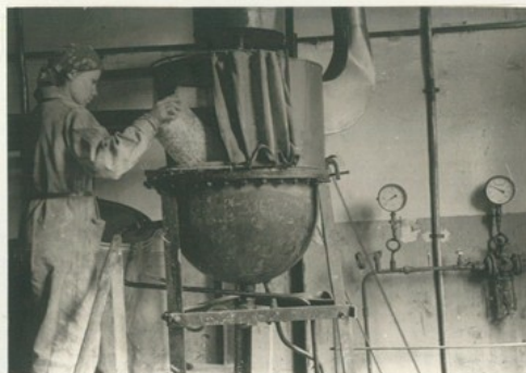
Изготовление ускорительных паст в пастомешалках, обеспечившее лучшее распределение ускорителей в резиновых смесях.
