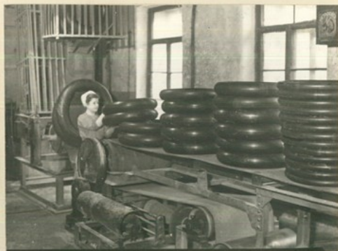
ПОДАЧА ГОТОВЫХ КАМЕР ЭЛЕВАТОРОМ НА СКЛАД.
