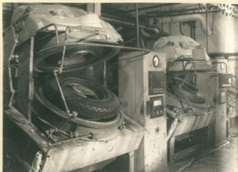
Индивидуальные вулканизаторы для покрышек в открытом виде.
