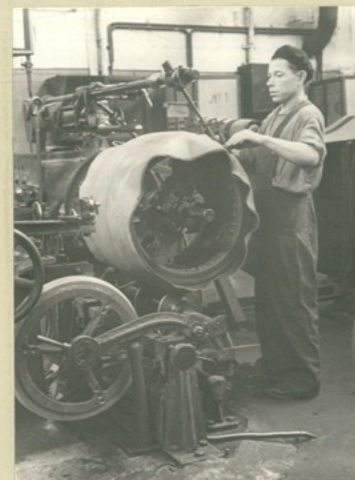
Сборка покрышек на станке СПД-1 с установленным левым шаблоном (до его полной модернизации).
