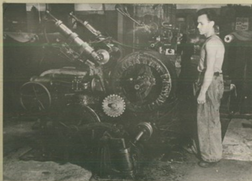
Сборка покрышек на модернизированном станке СПД-1 (описание станка см. дальше)
